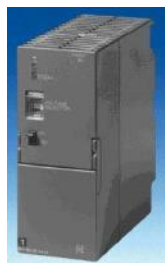
1x Stromversorgung PS 307, AC 120/230V; DC 24V, 5A
